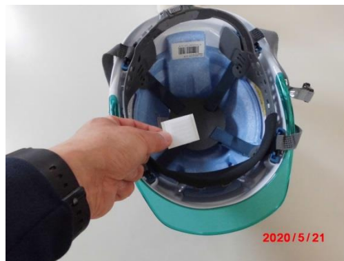
ヘルメット内部インナー部中央部に 面ファスナーを貼り付ける
